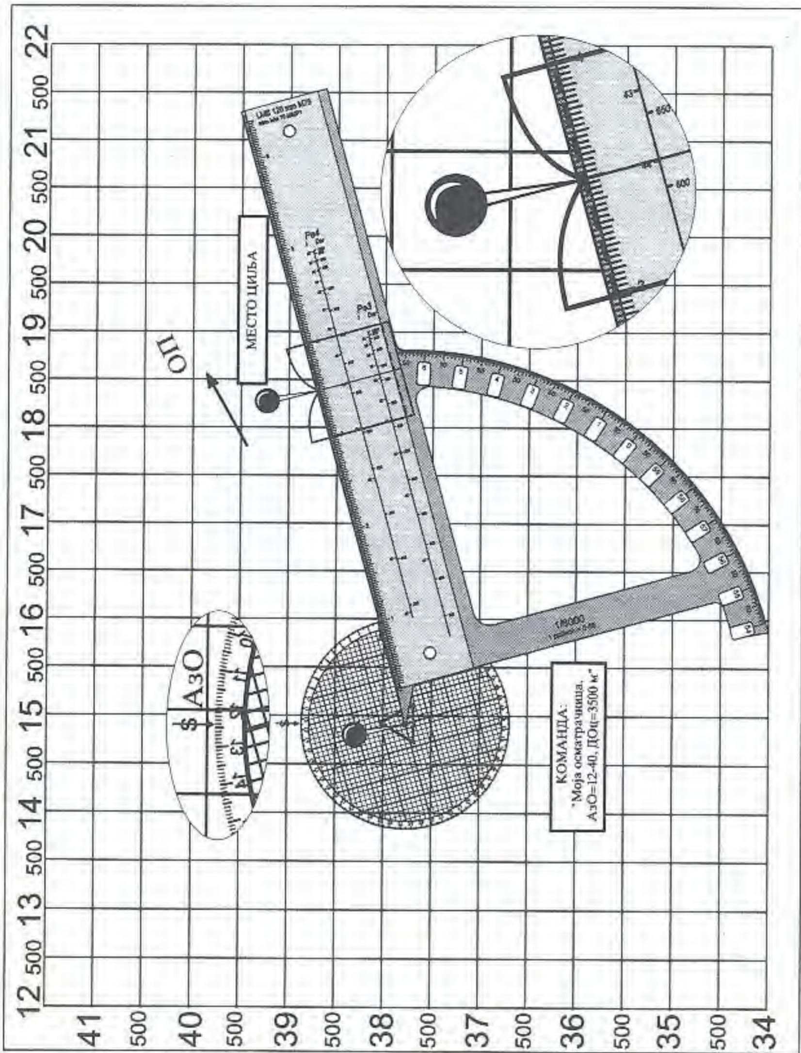
Слика б8. Наношење циља на планшету помоћу поларних координата
